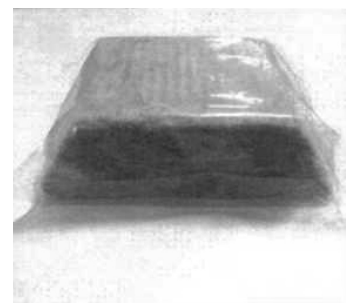
従来商品 ラクダパック ロックウール密度80kg/m 2 品にて 奥行100mmで耐火試験に合格
